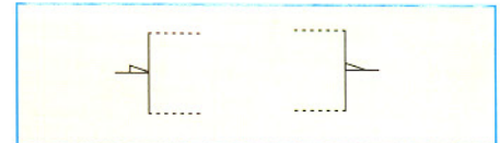
Bild 3: Die aktuelle DIN- und IEC-Norm schreibt die Darstellung der Schaltzeichen in Kastensymbolform vor.
