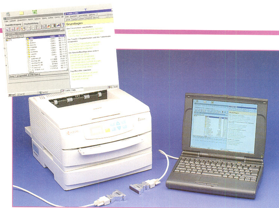
Bild 2: Standardanwendung für IrDA - Der mobile Rechner druckt per Infrarot auf dem Bürodrucker.
