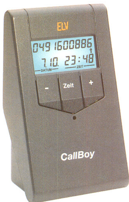
Bild 3: Der ELV-CallBoy stellt ein an jeder TAE-Dose installierbares Zusatzgerät dar, das die komfortable Auswertung der CLIP-Funktion ermöglicht.
