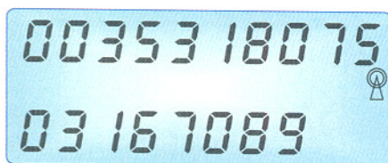
Bild 6: Die komplette Rufnummernanzeige kann bis zu 20 Stellen umfassen, die bei entsprechender Programmierung beide Hauptzeilen des Displays belegen können.
